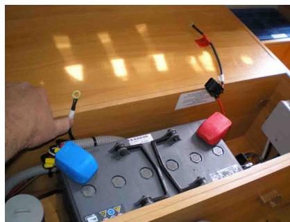
Ahora sólo falta conectar la alimentación eléctrica a la batería. El cable viene con terminales redondos para los bornes de la batería y con un portafusibles con fusible de 20 amperios. En caso de que el cable no llegue desde el techo, hay que prolongarlo.
