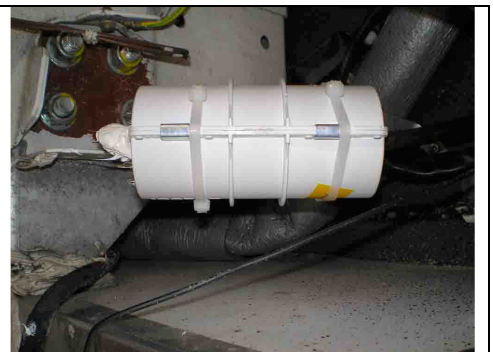
Ahora sólo falta conectar la alimentación eléctrica a la batería. El cable viene con terminales redondos para los bornes de la batería y con un portafusibles con fusible de 20 amperios. En caso de que el cable no llegue desde el techo, hay que prolongarlo.
