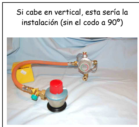
Ahora a montar: vista de la instalación original con SecuMotion
