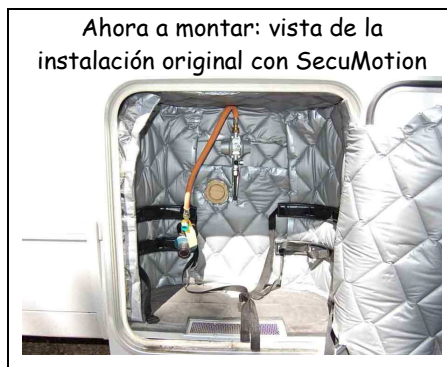
Lo primero es desmontar la lira de alta presión original y dejar solamente el SecuMotion.
