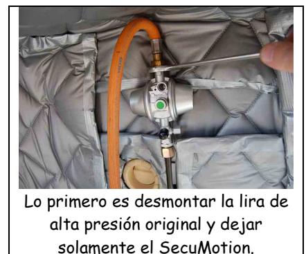
Ahora a montar: vista de la instalación original con SecuMotion
