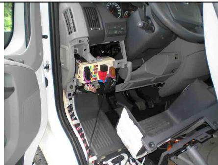
A continuación se desmonta el guarnecido para meter el cable que va al Led de cabina
