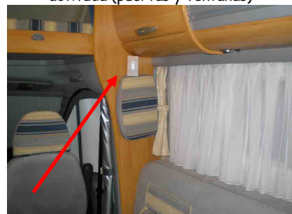
Instalación de detectores de presencia inalámbricos. Se pueden anular para cuando estamos dentro de la AC y queremos tener la protección perimétrica activada (puertas y ventanas)
