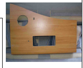
Aquí no se puede desmontar. Hay que hacer el agujero a "pulso" con la sierra de calar
