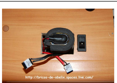
Para que no golpee la pila la "forro" de aislante y la meto dentro del hueco
