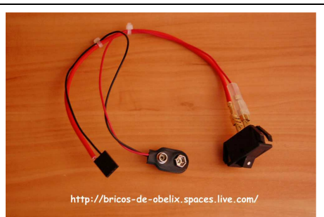
"Esquema" de la alimentación del amperímetro con interruptor.
