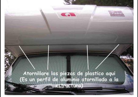
Atornillare las piezas de plástico aquí (Es un perfil de aluminio atornillado a la estructura)
