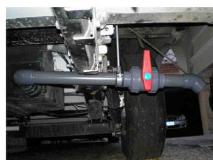
Para evitar que se mueva en vertical se pone una brida con varilla roscada
