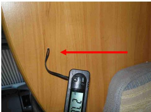
En primer lugar, perforamos el mamparo donde vamos a colocar el termómetro interior. Previamente he cortado el cable para que pase a su través. Una vez pasado el cable, lo empalmamos de nuevo para continuar pasando la sonda hacia donde nos hace falta.
