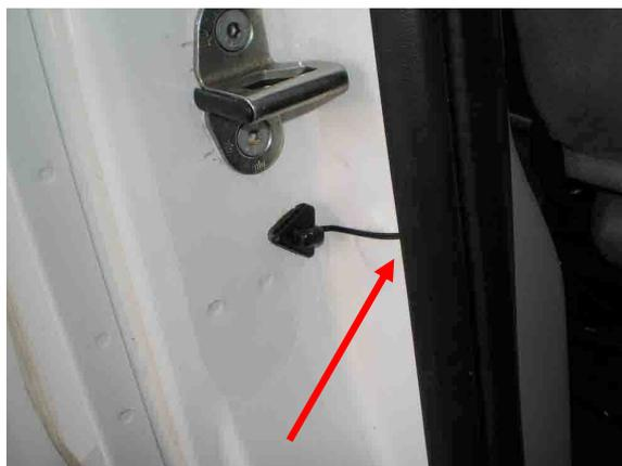
Una vez hemos llegado, levantamos el burlete de goma de la puerta (va a presión, por lo que solamente tendremos que presionar de nuevo para volverlo a montar).
