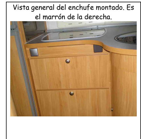
Mueble del televisor La instalación de 230 V a través del cargador tiene enchufes grises. La de 230 V a través del ondulador los he puesto marrones, para diferenciarlos
