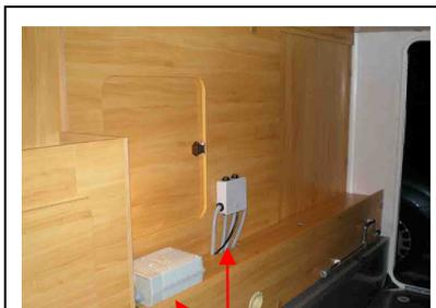
Se va a reposicionar el sistema de calefacción del suelo por hilo radiante, así como la caja de conexiones
