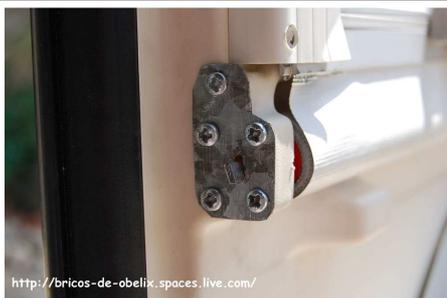
Detalle de la pieza ya montada con el eje asomando a su través
