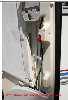
Detalle del varillaje de apertura
