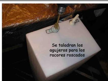
**Colocación del racor de entrada de agua sucia y respiradero**
