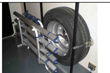
Pasamos una cincha con trinquete a través de los agujeros de la llanta (de las que se usan para atar equipaje en las bacas) de forma que la fijemos a las 2 barras verticales. Como es larga, la pasamos de atrás hacia adelante y otra vez de adelante hacia atrás
