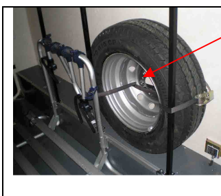
Fijarse en que se usan tornillos pasantes con tuerca autofrenante, para evitar que se aflojen con las vibraciones de la marcha. La cabeza es cónica para quedar al ras con la madera.
